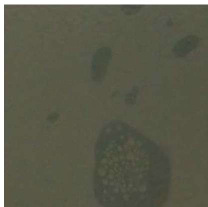
Рис. 7. Пластины после теста катаплазмой: а) пузырение покрытия по всей поверхности, б) пузырение и обесцвечивание покрытия, в) выделение клейкой субстанции на поверхности пластины.
