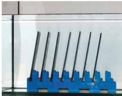
Рис. 5. Пластины в резервуаре с водой во время исследования стойкости покрытия к воздействию воды в соответствии с EN ISO 2812-2.
