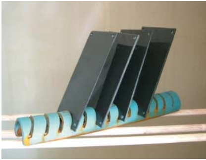
Рис. 4. Размещение пластины в камере влажности в соответствии с требованиями стандарта EN ISO 6270-2.
